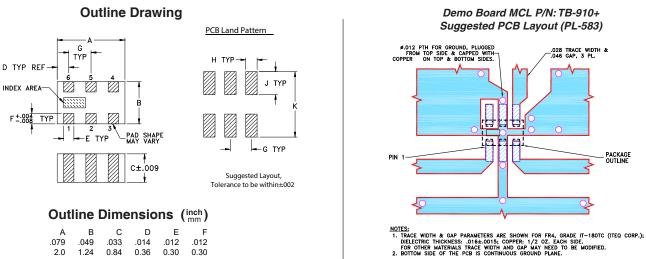
DENOTES PCB COPPER LAYOUT WITH SMOBC (SOLDER MASK OVER BARE COPPER).
